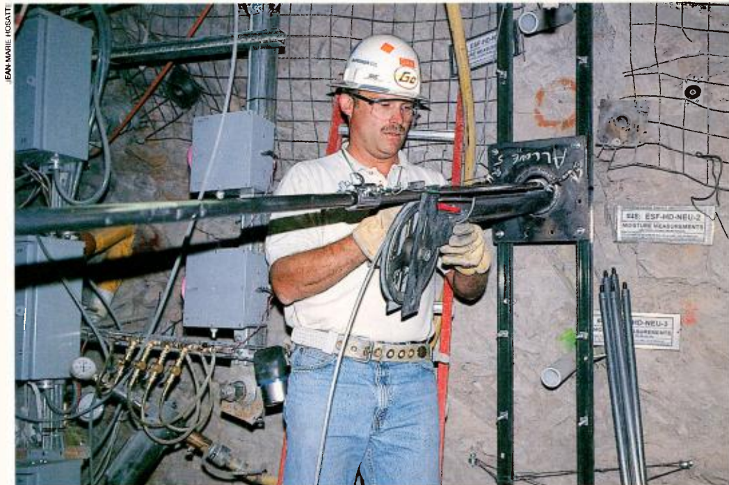
Injection de traceurs pour tester la résistance de la roche aux éventuelles fuites radioactives
