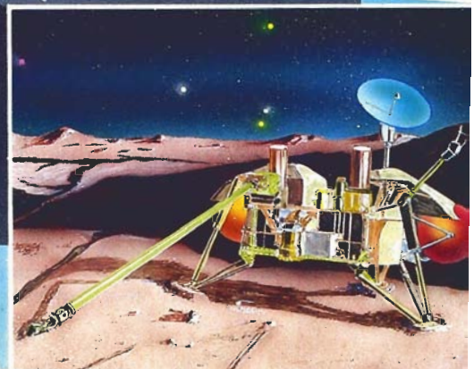
VIKING (U.S.A.) , équipé d'un générateur SNAP de 70 W.
