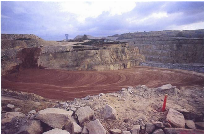
Stockage des résidus de traitement des minerais dans la MCO de Bellezane. (Photo COGEMA).
