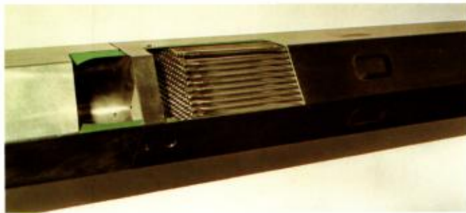
Maquette d'élément combustible : vue des faisceaux des aiguilles combustibles.
