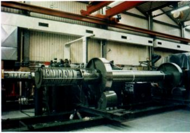
Royal Schelde - Avril 1981 - Échangeur RUR - Introduction du faisceau tubulaire dans la virole de protection.
