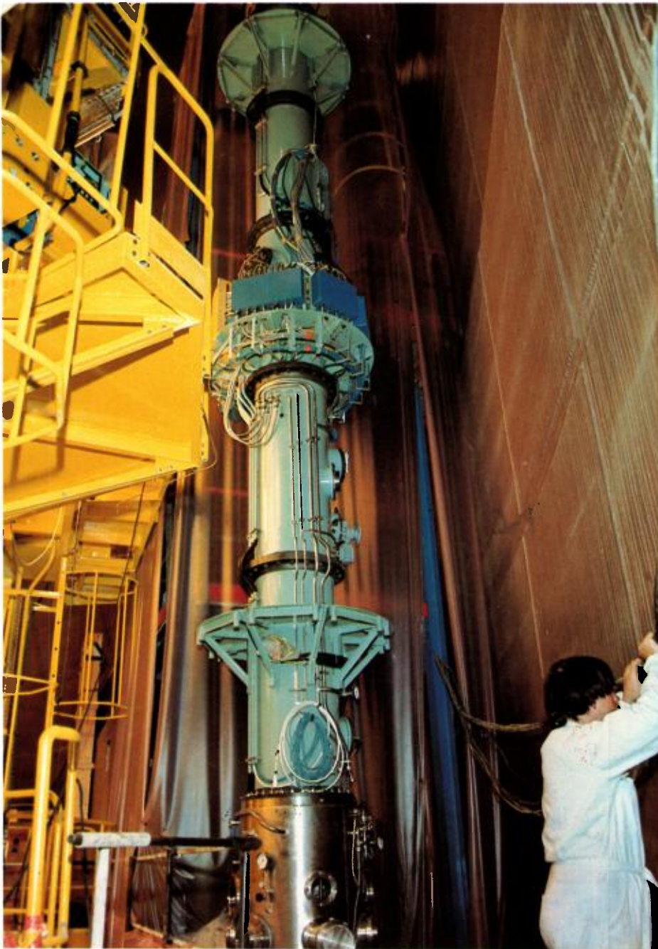
Vue générale de la partie hors réacteur de la machine de transfert.
