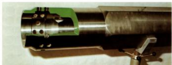
Extrémité supérieure de la maquette d'assemblage combustible.
