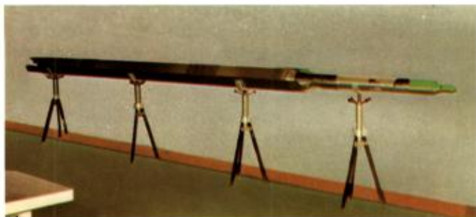
Vue d'ensemble de la maquette à l'échelle 1 d'un assemblage combustible.
