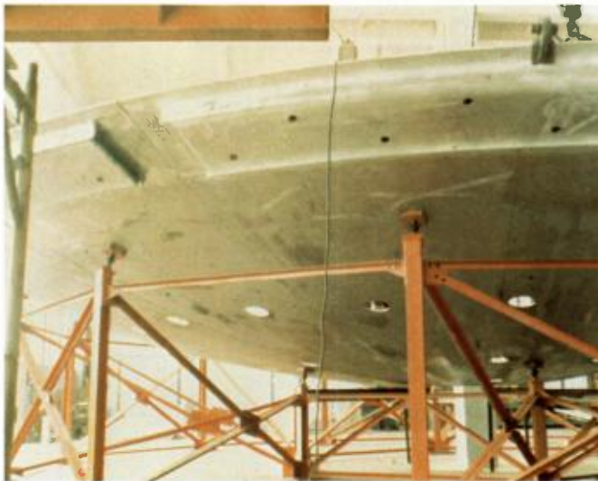
Vue par-dessous de la tôle de carénage du cendrier (double fond).
