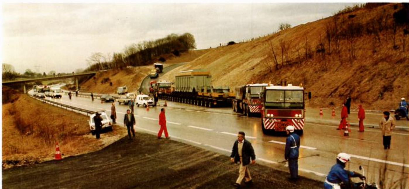
Traversée de l'autoroute A.43 par le convoi routier d'un transformateur.
