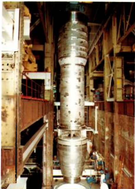
Vue d'ensemble d'une pompe primaire en montage sur le banc de Gennevilliers.
