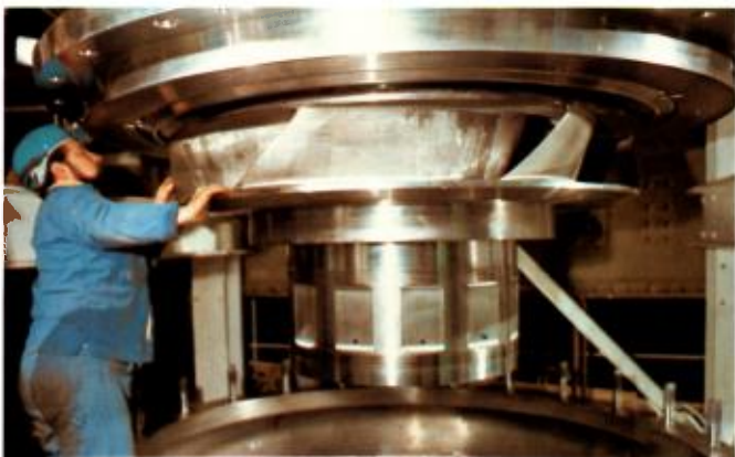
Vue du rouet de la pompe primaire et du tourillon de palier inférieur de cette pompe.
