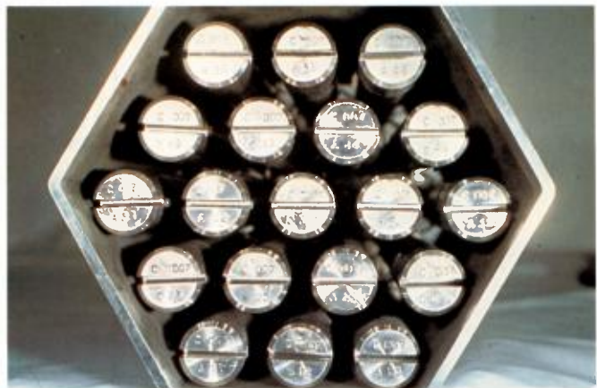
CERCA - Décembre 1981 - Guide de neutrons - vue du réflecteur en acier.
