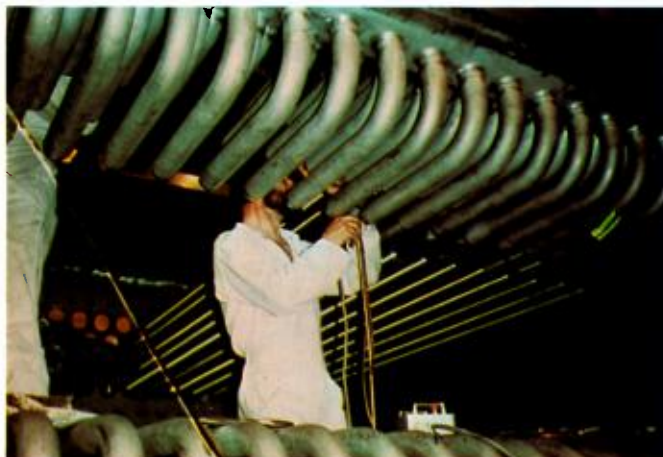
Stein Industrie - Septembre 1981 - Échangeurs sodium-air – soudage des tubes ailetés.
