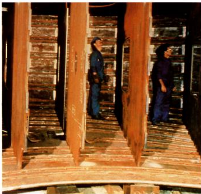
Août 1978 – Neyrpic. Assemblage d'une demi-structure du grand bouchon tournant.
