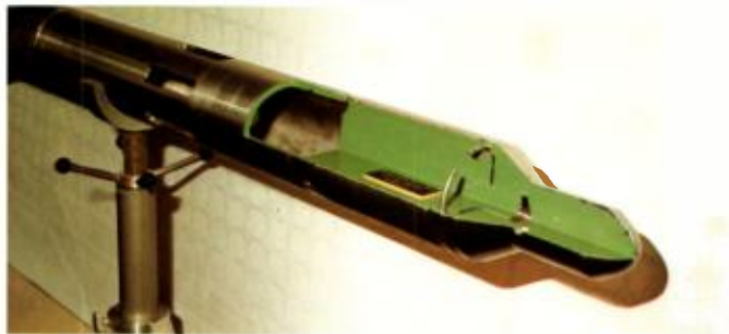
Vue du pied de la maquette d'assemblage combustible.
