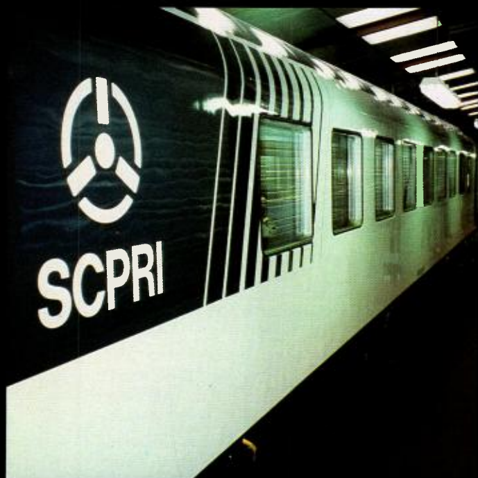
Figure 4 ▲ Voiture-rail spectrométrique : 32 postes de mesure.
