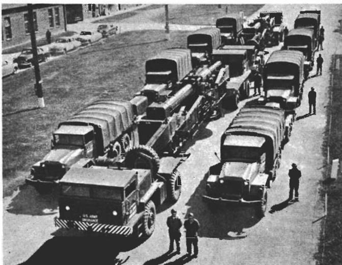
● Une batterie autonome d'artillerie atomique comprend deux canons de 280 mm, quatre tracteurs et huit camions ; ne comportant que des véhicules tous terrains, elle peut atteindre 55 km/h. L'ensemble tube-affût, qui pèse 85 t, repose en position de route sur les plates-formes de deux tracteurs.
