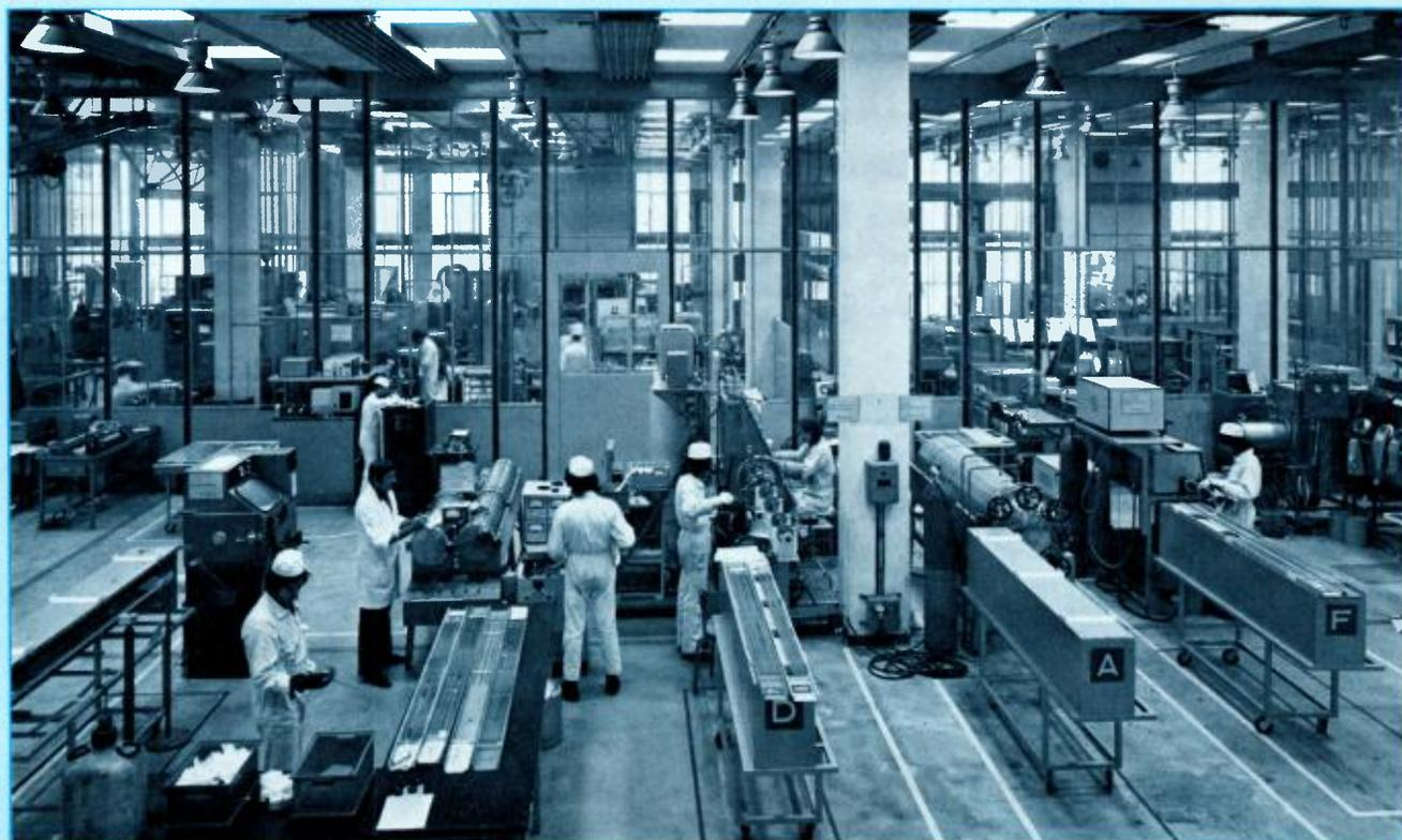
*hall de montage d'aiguilles à oxyde d'uranium
