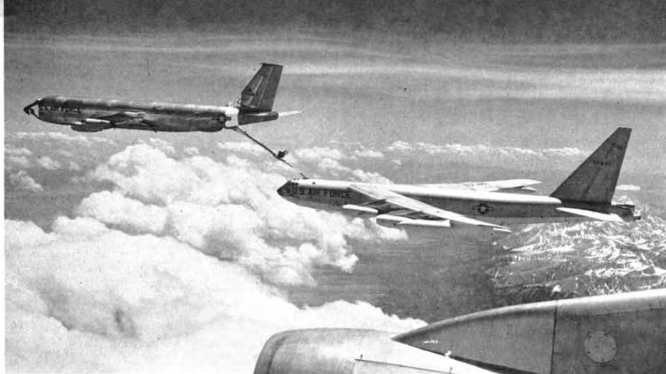
Un B 52 ravitaillé en plein vol. Il utilise le TR 4, carburant terriblement volatil. L'avion-citerne en porte 40 tonnes.
